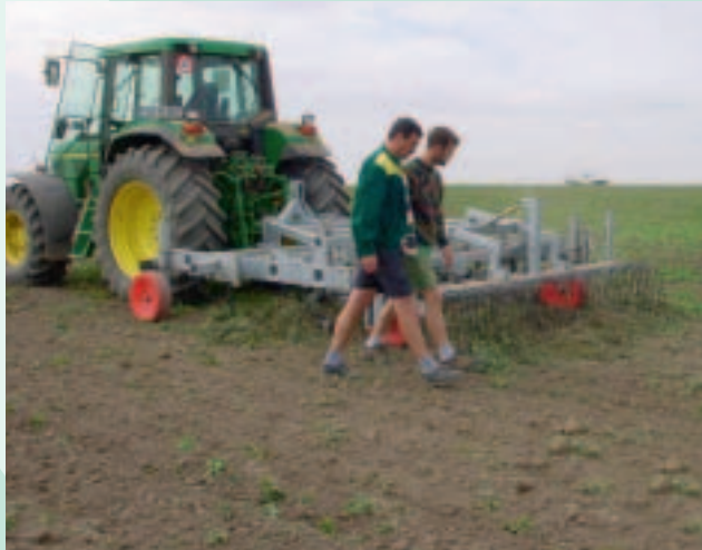
Kontrollgang: Die «WeCo-Dyn»-Grubber sollen die Wurzeln der Unkräuter auf maximal 5 cm Tiefe abschneiden.
